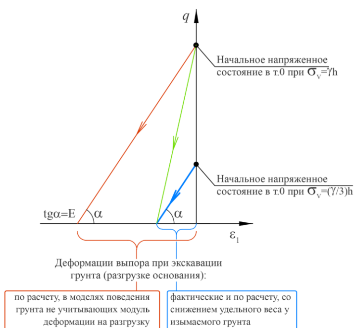
Рисунок 1 - График зависимости деформаций от напряжений при экскавации грунта (разгрузке основания), в том числе для расчета со снижением удельного веса изымаемого грунта (синим)
