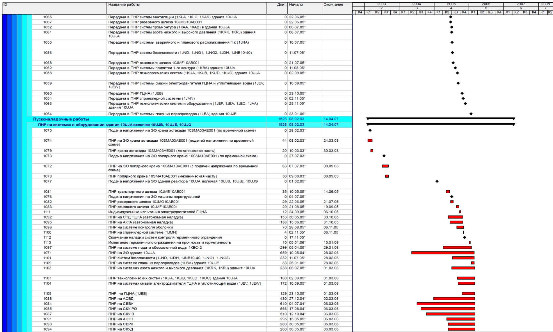
Рисунок 29. Пример (выписка) типового графика ПНР 3-го уровня для систем и оборудования здания 10UJA.
