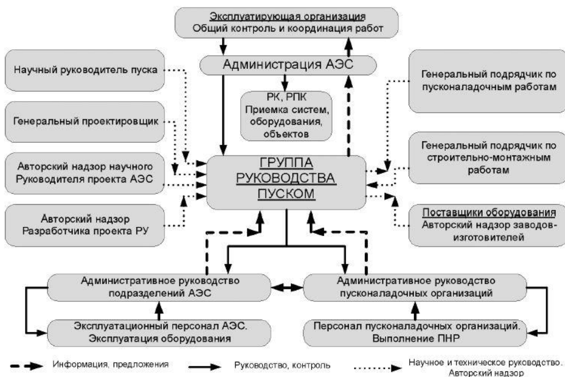
Принципиальная схема внешних взаимодействий организаций, участвующих во вводе энергоблока АЭС в эксплуатацию
