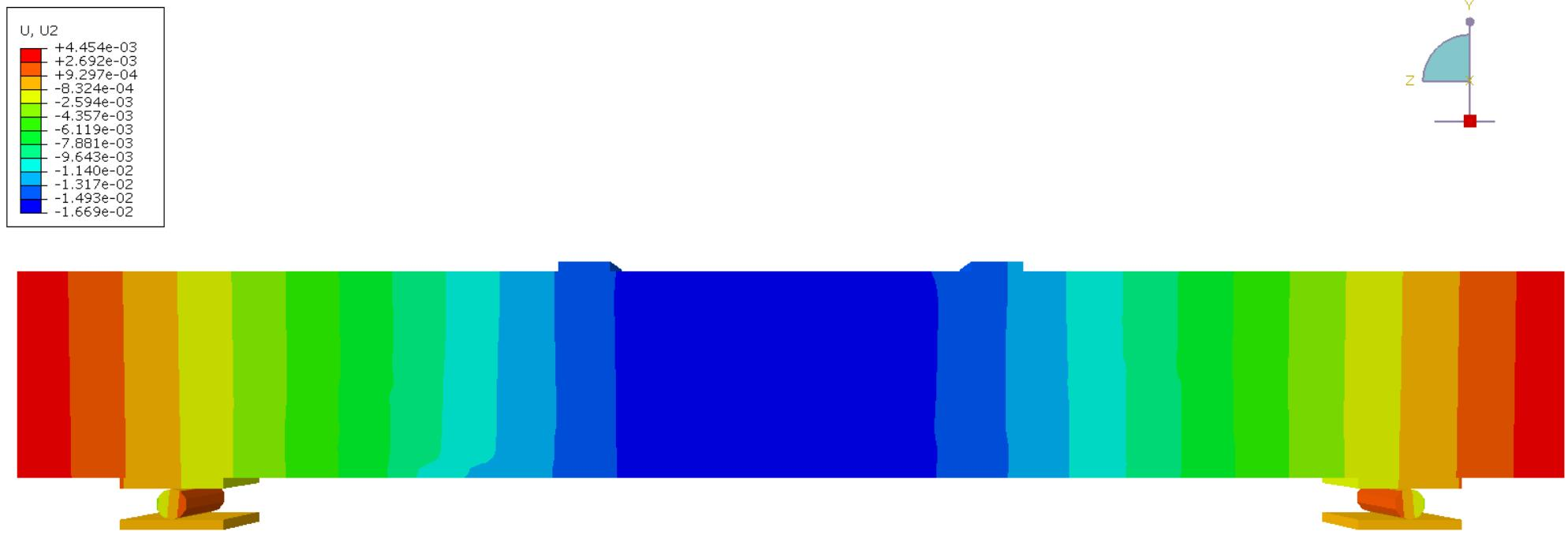
Рисунок А.1 – Изополя вертикальных перемещений в момент перед разрушением для образца ВО-І-01
