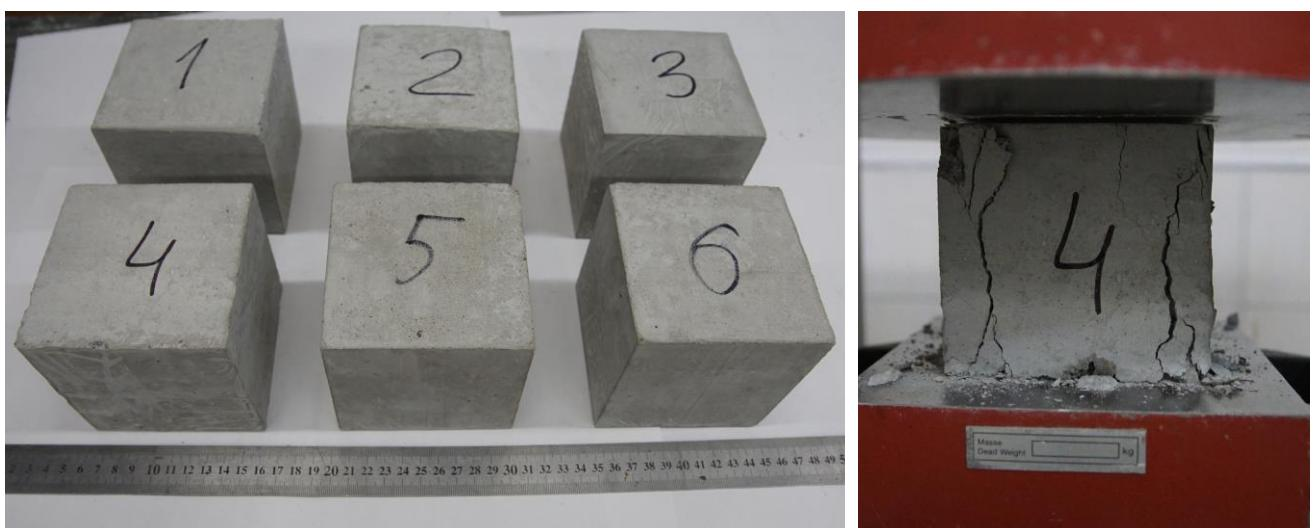
Рисунок 2.9 – Испытание бетонных кубов
