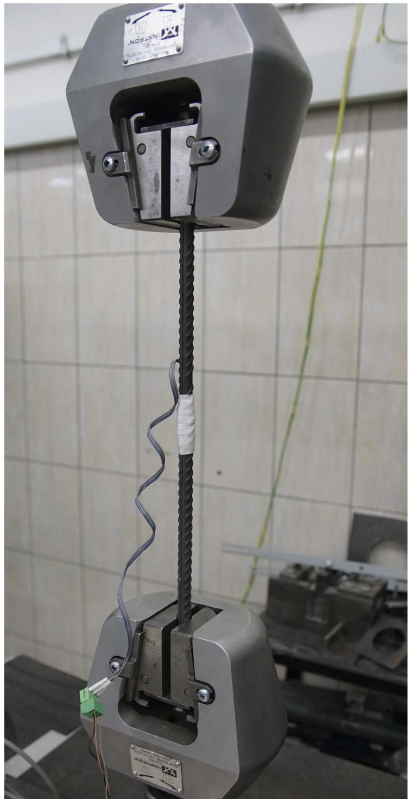
Рисунок 2.15 – Испытание арматуры класса А500
