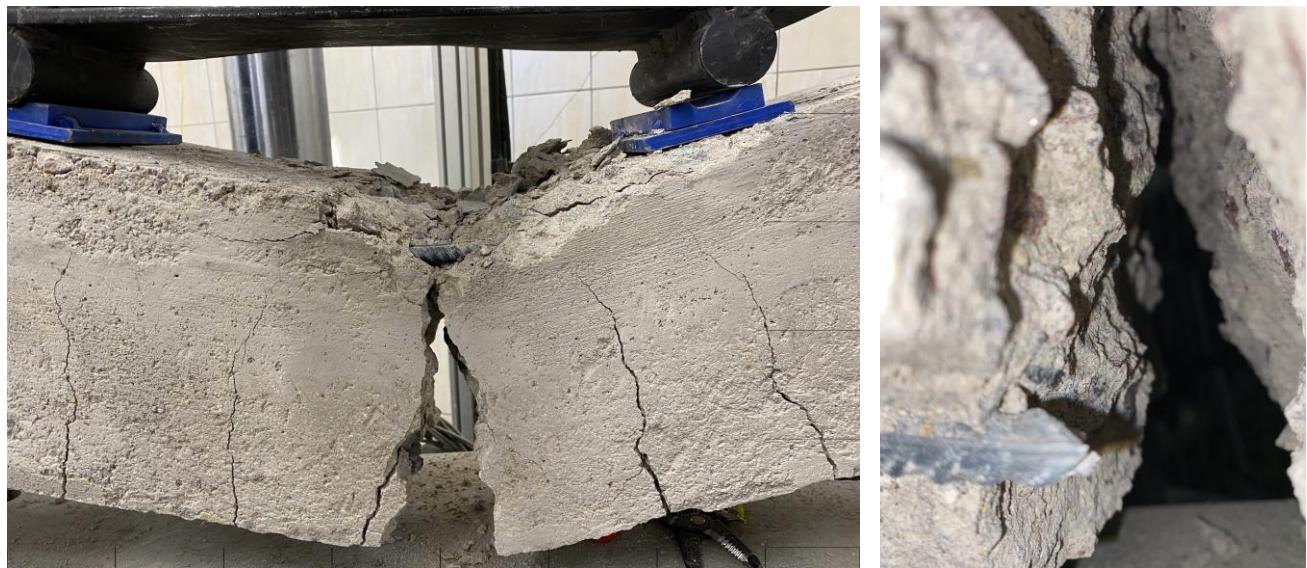
Рисунок 2.72 – Характер разрушения образцов VII серии
