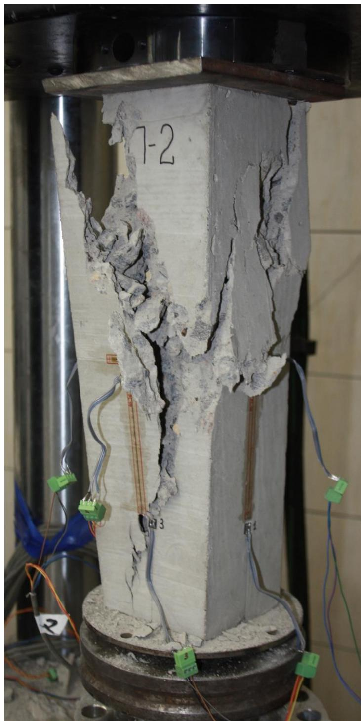
Рисунок 2.10 – Испытание образцов призм
