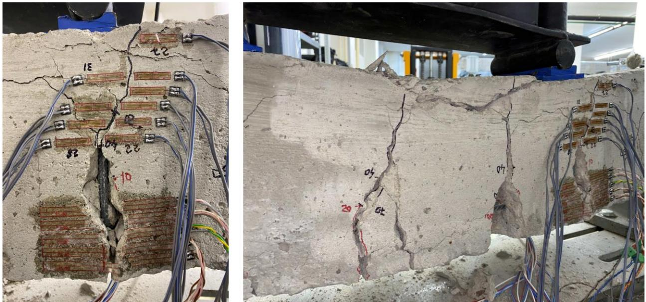
Рисунок 2.44 – Характер разрушения образцов III серии
