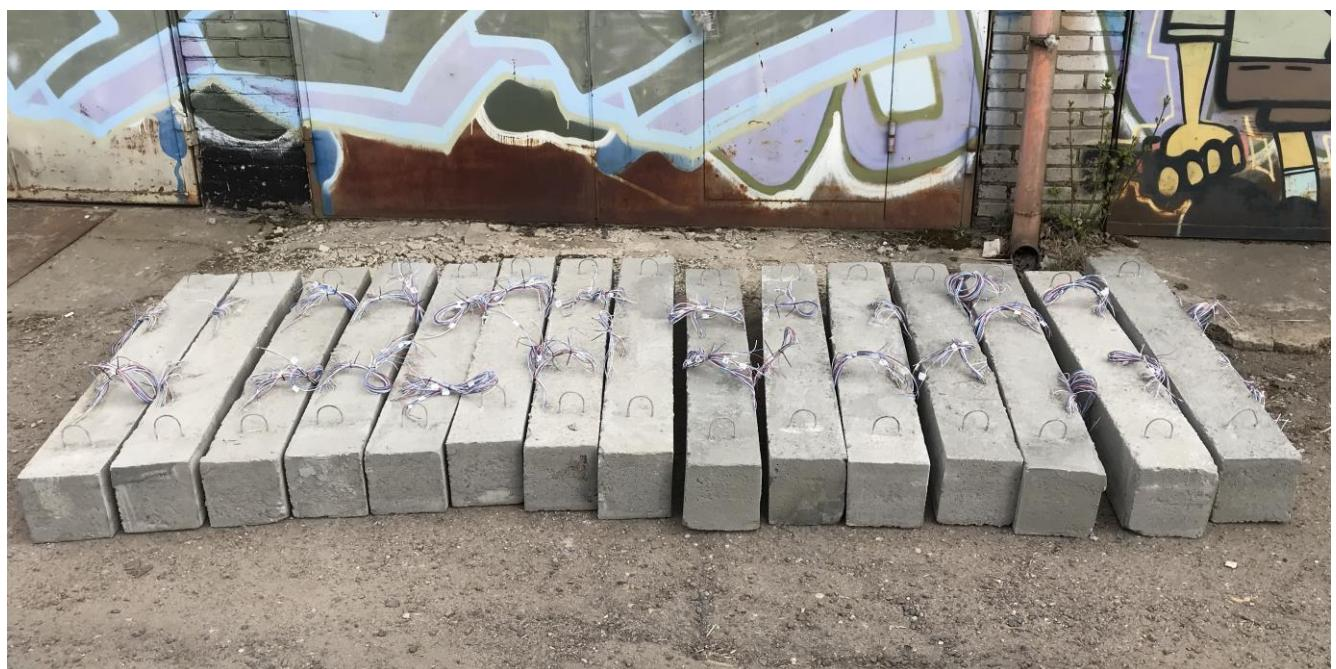
Рисунок 2.3 – Распалубка опытных образцов
