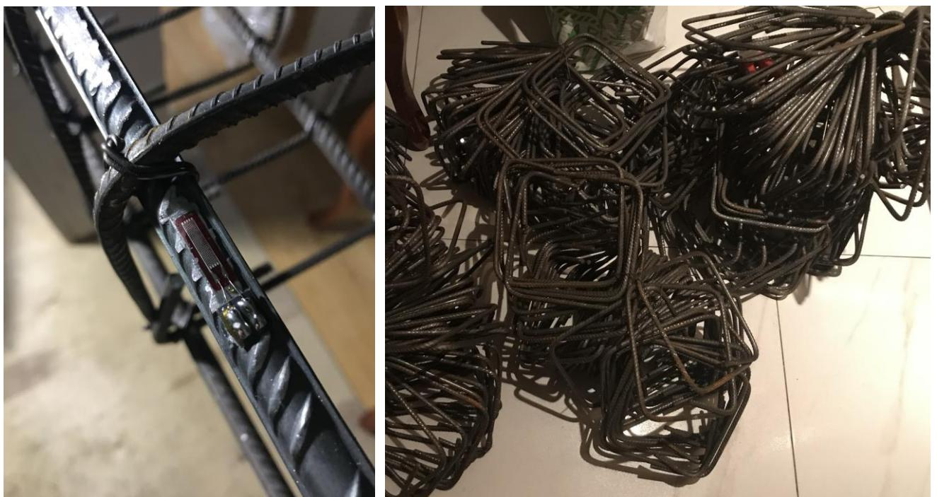
Рисунок 2.1 – Наклейка тензорезисторов на арматуру и сборка каркасов
