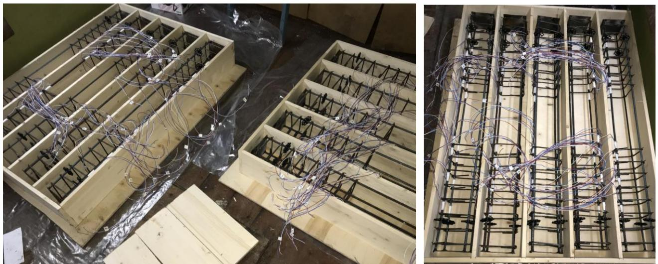
Рисунок 2.2 – Арматурные каркасы в опалубке
