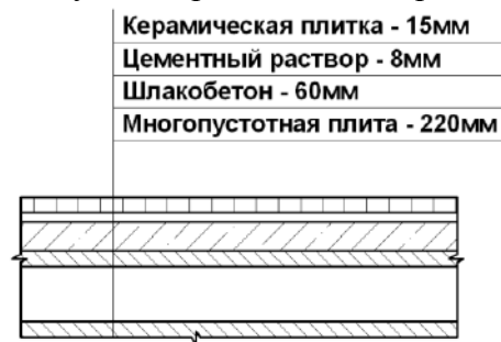
Рис. 1. Конструкция панели перекрытия
