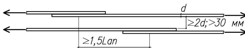
Рис. 31. Схема установки стержней с окончанием «вразбежку»
