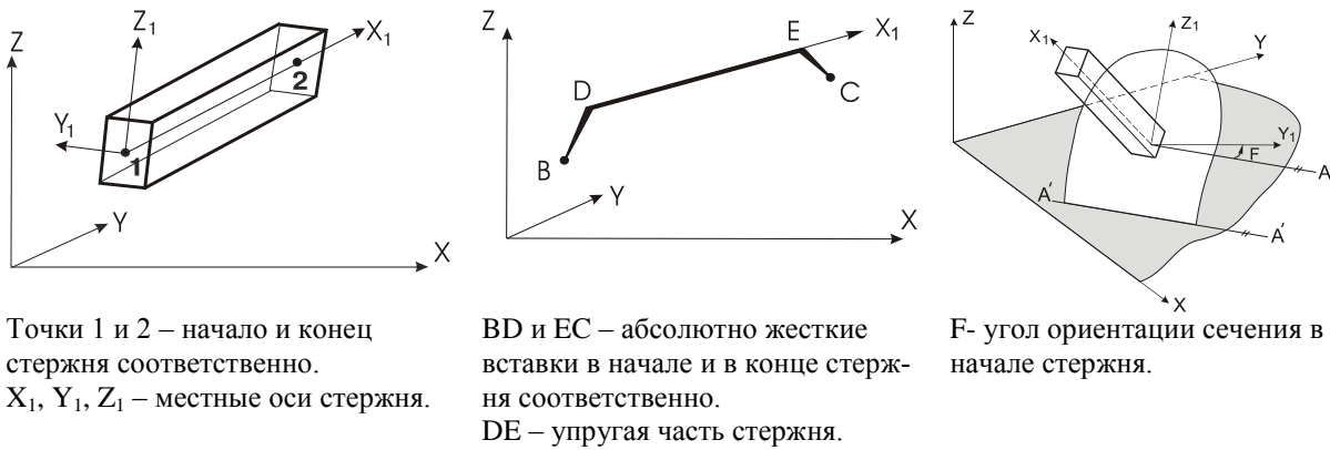
Рис. П.27.8. Местные оси и абсолютно жесткие вставки для КЭ тип «стержень»
