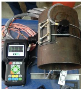
Система измерения скорости коррозии на стендовых испытаниях.
