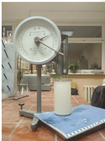
Определение размера частиц тонкомолотого перлита с помощью торсионных весов
