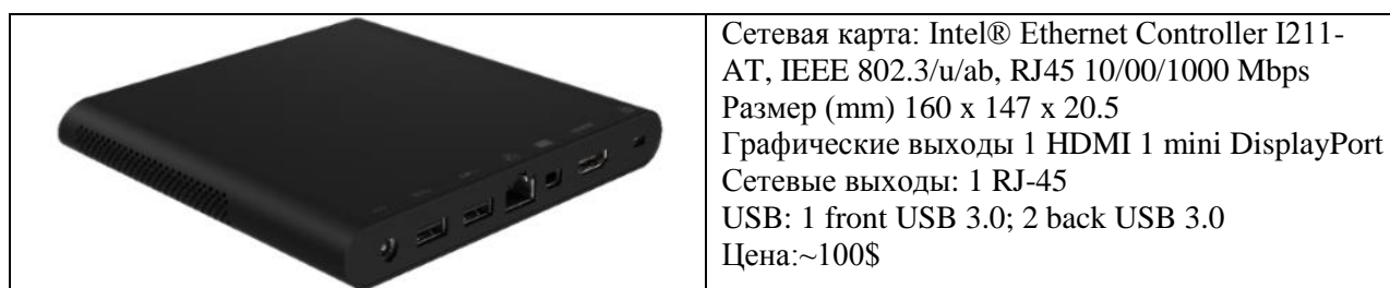
Рис. 2. Док-станция Intel® Compute Card Dock DK132EPJ и её основные характеристики
