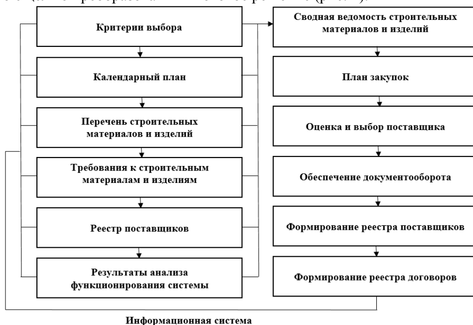
Рис. 1. Информационная система материального обеспечения объекта строительства
