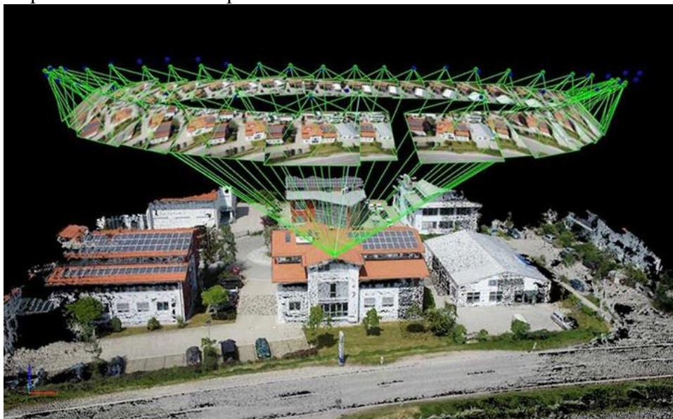
Рис. 3. Обработка фотографий с помощью технологии машинного зрения и создание 3D-модели
